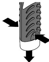
1. Drücken Sie auf beiden Seiten auf die Druckflächen und ziehen Sie den Batteriefachdeckel vom Gerät ab.
